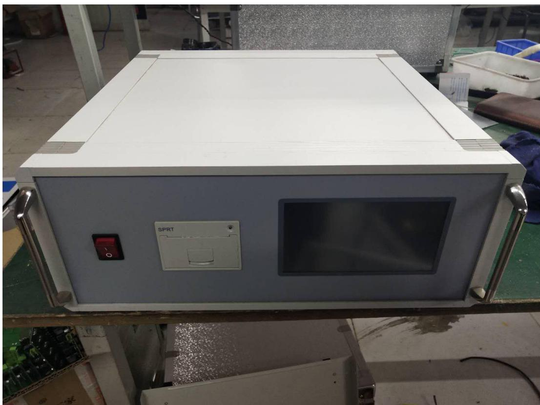
该仪器采用全新电源技术，具有体积小、重量轻、输出电流大等特点。整机由单片机控制，自动完成自检、数据处理、显示等功能。仪器测量精度高，操作简便，可实现变压器直流电阻的快速测量。
