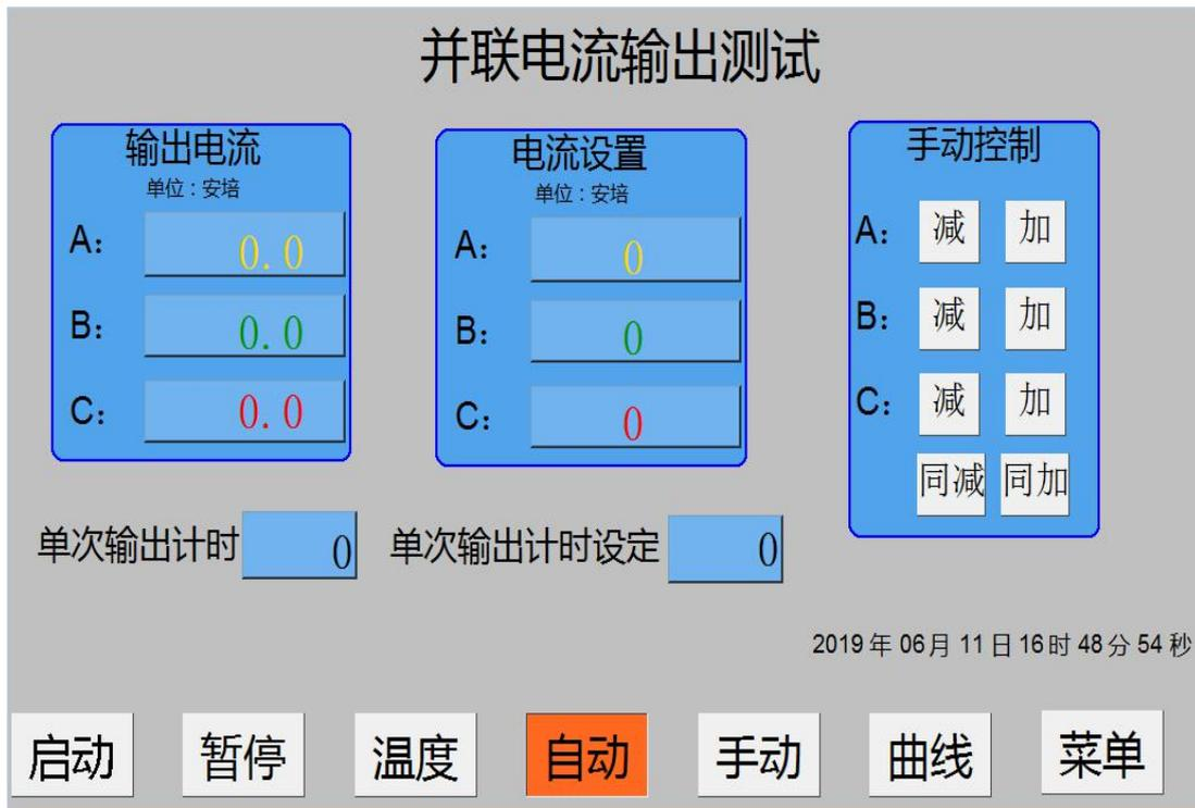
三相并联大电流手动，自动，测试界面如上图所示
