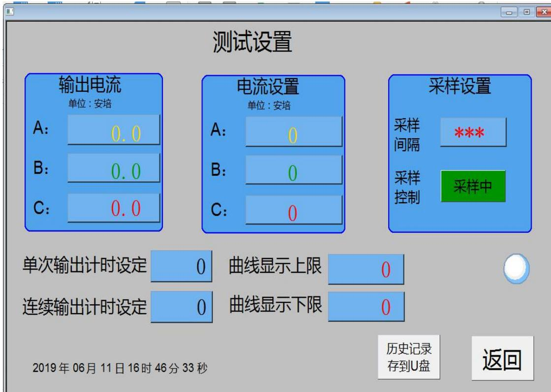
采样设置，可以对采样时间进行设置。已经对采样进行控制，如果勾选暂停采样，系统将停止所有的采样，如电流。所做实验将没有任何数据记录。
